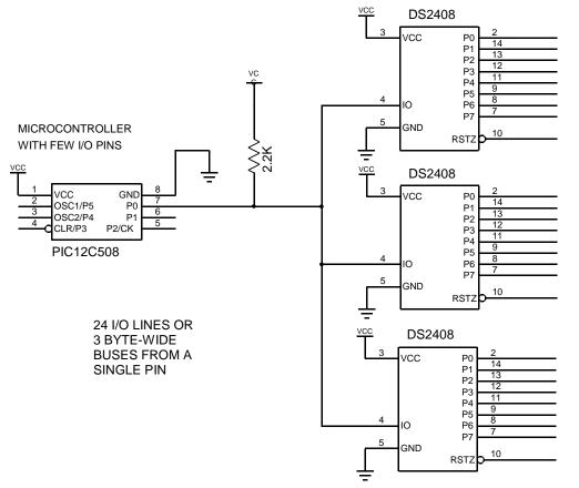
Figure 20. DS2408 AS μC-OPERATED KEYBOARD SCANNER
