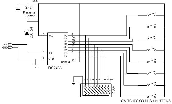
Figure 22. DS2408 AS MULTIPURPOSE SENSOR/ACTUATOR
