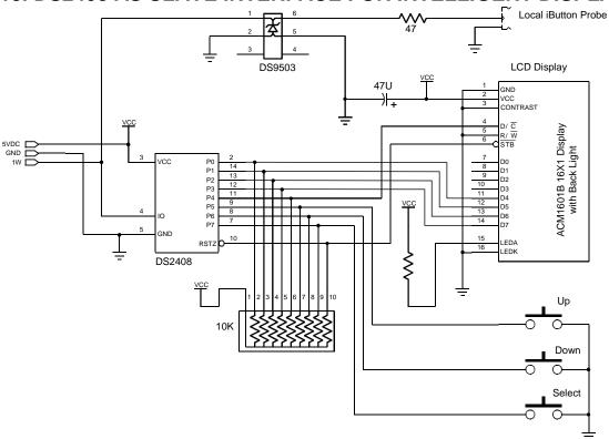
Figure 19. DS2408 AS MICROCONTROLLER PORT EXPANDER
