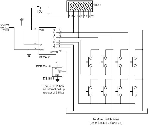
Figure 21. DS2408 AS PARASITE-POWERED PUSH-BUTTON SENSOR
