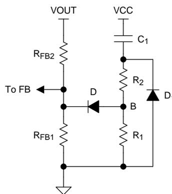
**Figure 11. Soft-Start Circuit**
